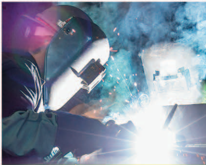
溶接ヒューム
