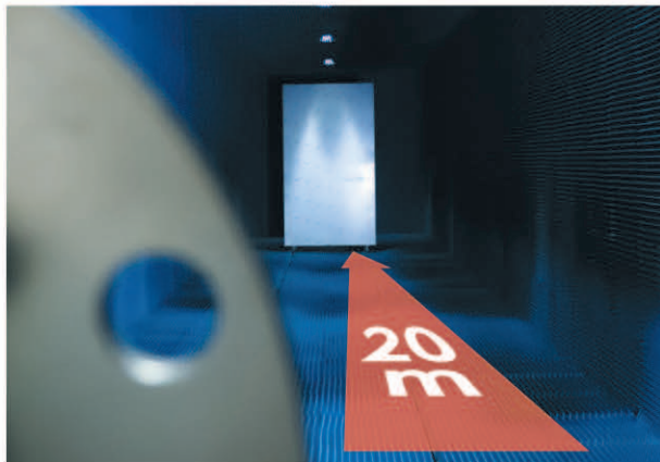
写真 「Waveラボ」内の電波暗室
